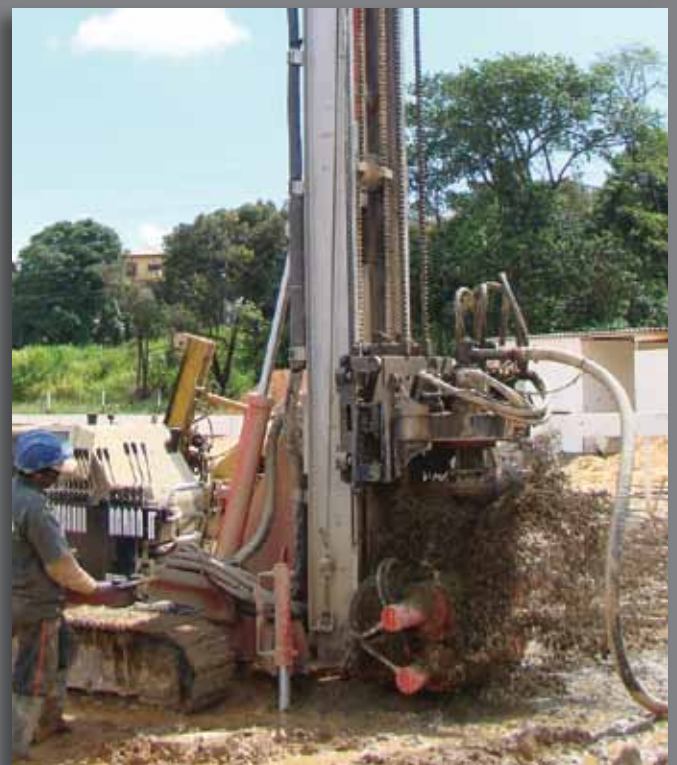
Trabalhando com martelo de fundo de furo - Working with down the hole hammer
